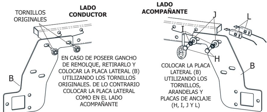
**ATENCIÓN:** NO AJUSTAR TOTALMENTE LAS PLACAS HASTA COLOCAR EL TRAVESAÑO (A)
